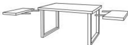
3. Wkładki należy wsunąć prowadnicami w zamontowane pod blatem 2 metalowe otwory następnie każdą wkładkę należy przykręcić do blatu stołu za pomocą 4 śrub „E”.
