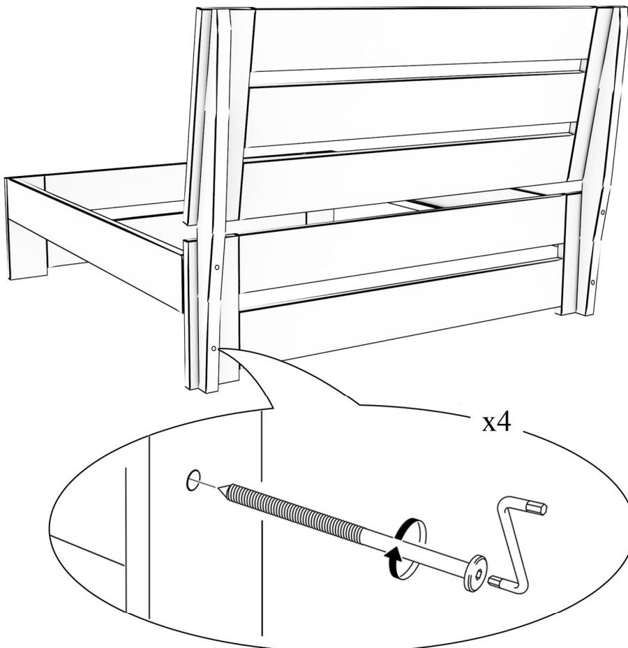
PL : Dla wzmocnienia konstrukcji zaleca się przykręcenie stelaża do ramy łóżka
